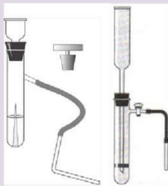
Рис. 7. Прибор для получения и собиария газов
